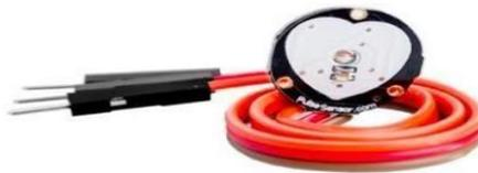
Gambar 2. Sensor Kg011 untuk mengukur denyut nadi
