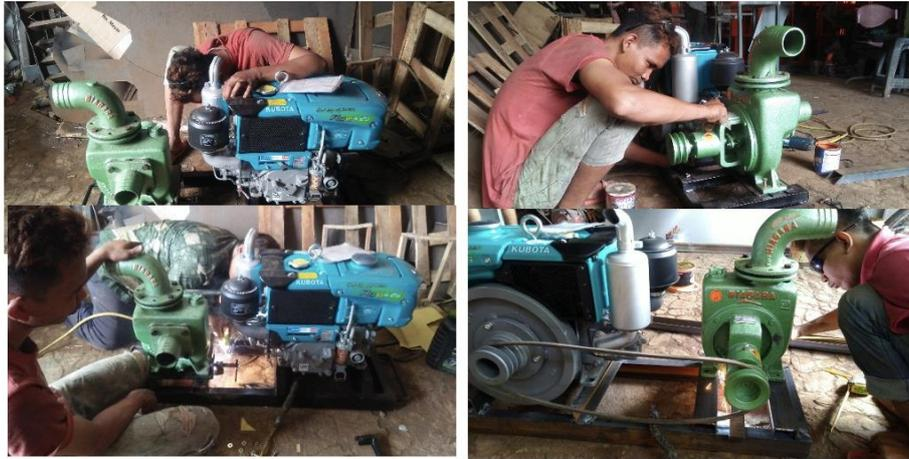
Gambar 6. Assembly mesin diesel dan pompa ke rangka
