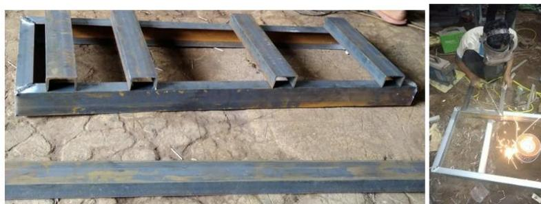
Gambar 5. Rangka/ Chasis pompa
