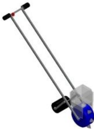
Gambar 1. Rancangan Akhir Produk Electric Row Seeder Hasil Brainstorming
