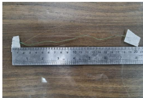
Gambar 8. Filamen hasil uji tarik
