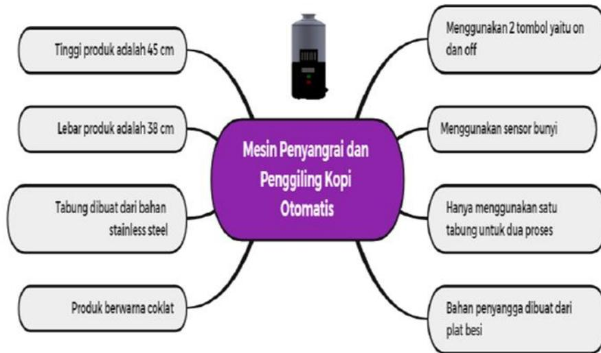
Gambar 2. Kesimpulan *Mind Map* Perancangan Alat Penyangrai dan Penggiling Kopi Otomatis
