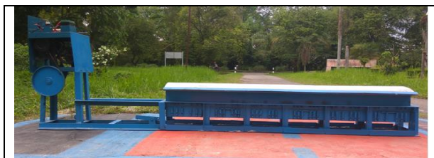
Gambar 1. Peralatan pembangkit listrik menggunakan speed bump
