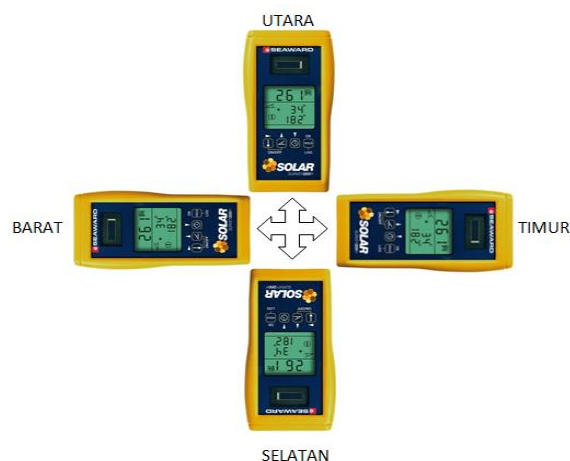
Gambar 4. Pemasangan pada Perbedaan Arah Mata Azimuth.
