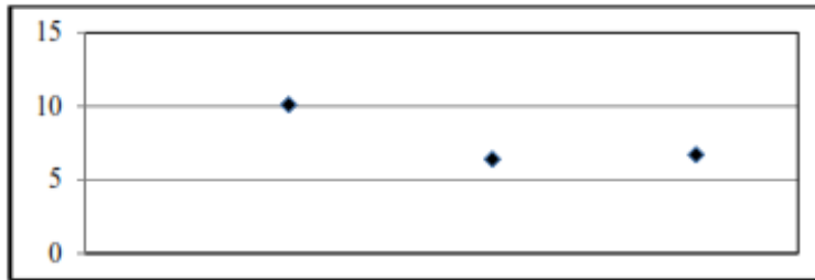
Gambar. 3. Perbandingan Parameter kekasaran (IRI) untuk tiga tekstur permukaan jalan (10,1 aspal lama,6,4.aspal baru dan 6,7.beton)
