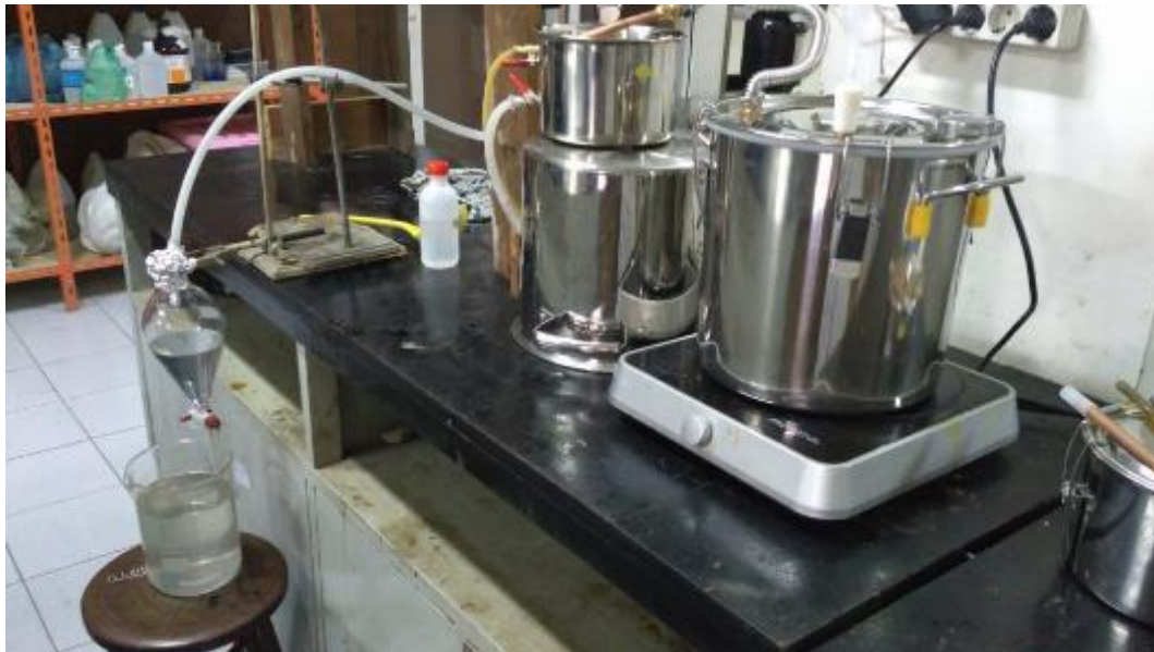
Gambar 5. Penyulingan Gaharu dengan Metode Kukus di Laboratorium
