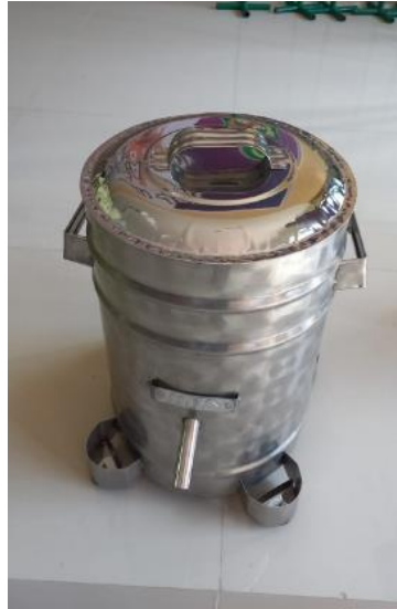
Gambar 5. Mesin peniris minyak (spinner) kapasitas 3 kg
