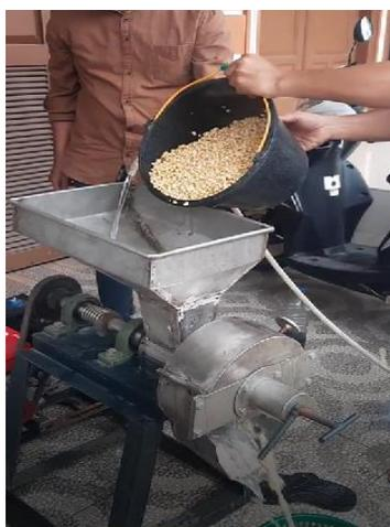
Gambar 1. Pengoperasian Alat Pemecah Kedelai
